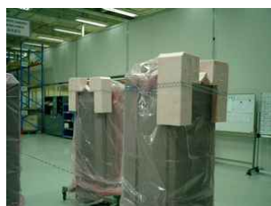
Estaciones base envueltas en una bolsa ESD y espumas de PE para el transporte
